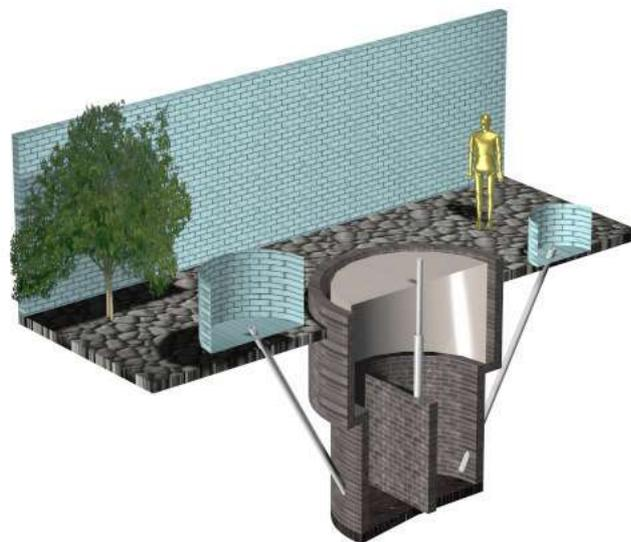
Figura 5. Vista tridimensional do biodigestor modelo Indiano.
